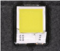
図2. シリコン樹脂の損傷例
